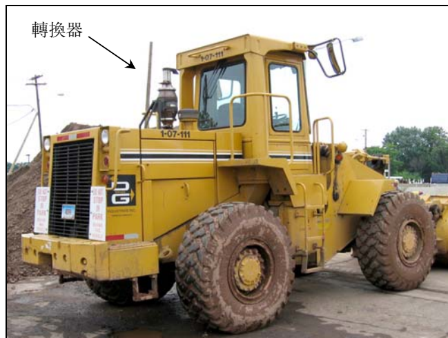
圖 1 I-95 NHHC 項目中改用氧化催化劑的建築機械
